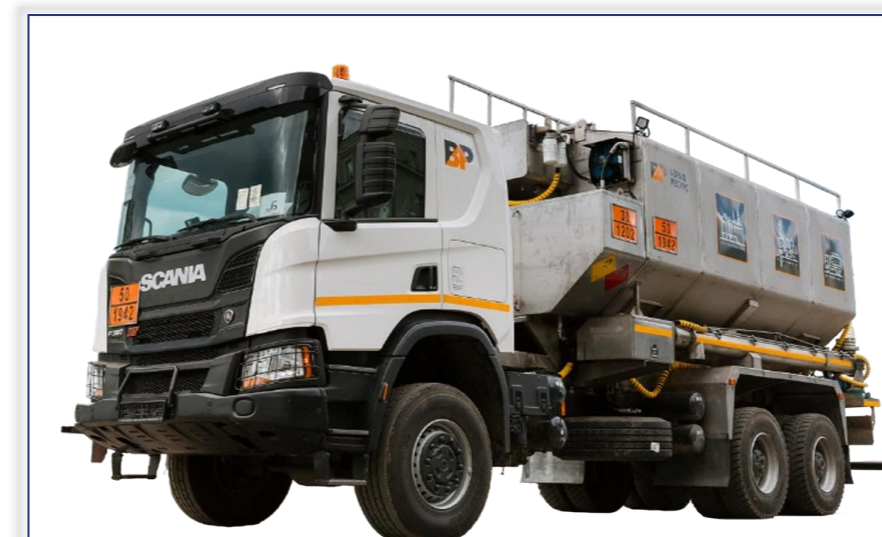
TDR.ANFO-15 Тип ВВ: гранулированные Заказчик: ООО «Взрыв-Ресурс» Шасси: SCANIA
