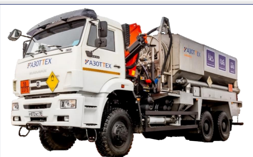
TDR.REPUMP-14-КМУ Тип ВВ: эмульсионные Заказчик: АО «Полюс Вернинское» Шасси: КАМАЗ
