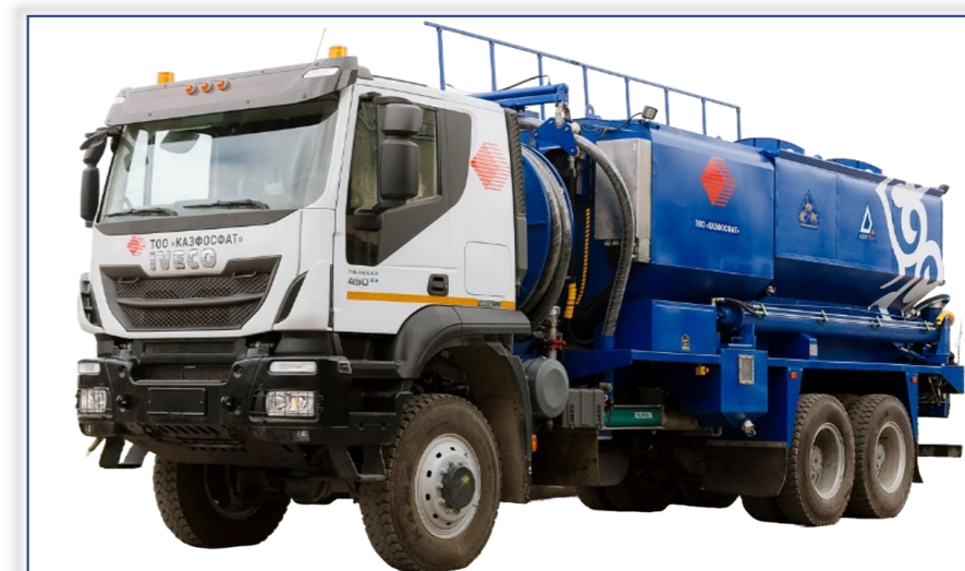
TDR.TTT-20 Тип ВВ: эмульсионные/гранулированные Заказчик: АО «Горные Машины» Шасси: IVECO
