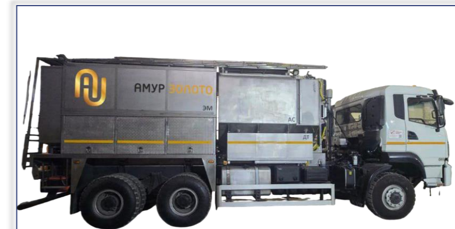
TDR.TTT-15 Тип ВВ: эмульсионные/гранулированные Заказчик: ООО «АМУР ЗОЛОТО» Шасси: ХАНТ
