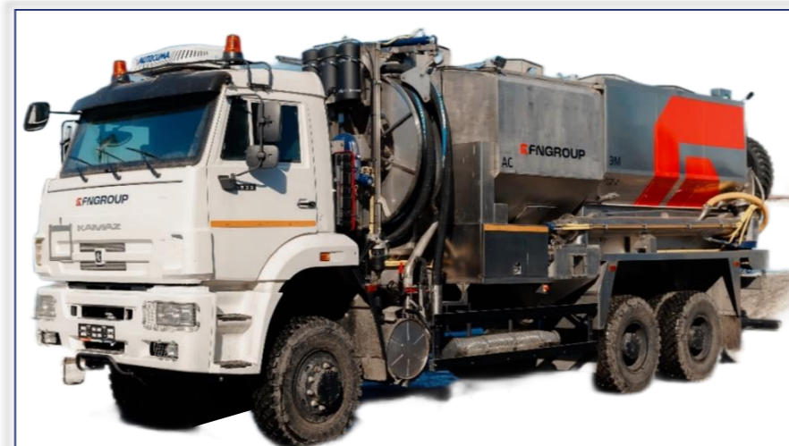
TDR.TTT-15 Тип ВВ: эмульсионные/гранулированные Заказчик: ООО «ФН Сервис» Шасси: КАМАЗ
