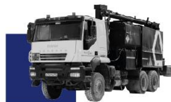
TDR.TTT-14 Тип ВВ: эмульсионные/гранулированные Заказчик: ООО «АЗОТТЕХ» Шасси: IVECO
