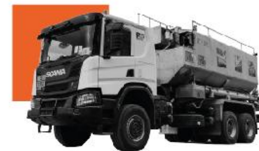
TDR.ANFO-15 Тип ВВ: гранулированные Заказчик: ООО «Взрыв-Ресурс» Шасси: SCANIA
