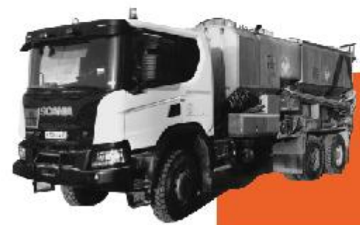
TDR.TTT-15 Тип ВВ: эмульсионные/гранулированные, Заказчик: АО «Полиметалл» Шасси: SCANIA
