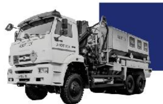
TDR.REPUMP-14-КМУ Тип ВВ: эмульсионные Заказчик: АО «Полюс Вернинское» Шасси: КАМАЗ
