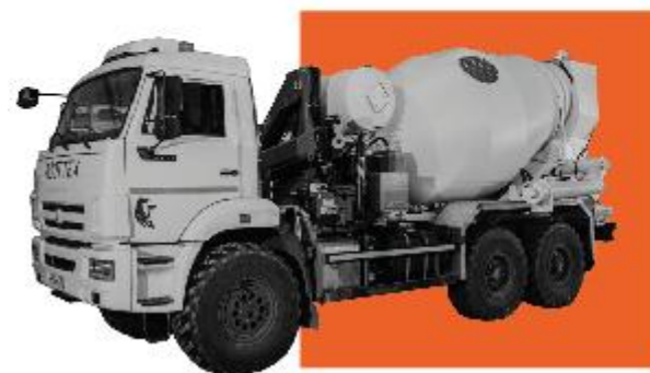
TDR.ANFO-7Б-КМУ Тип ВВ: гранулированные, многокомпонентные Заказчик: АО «Полюс Алдан» Шасси: КАМАЗ
