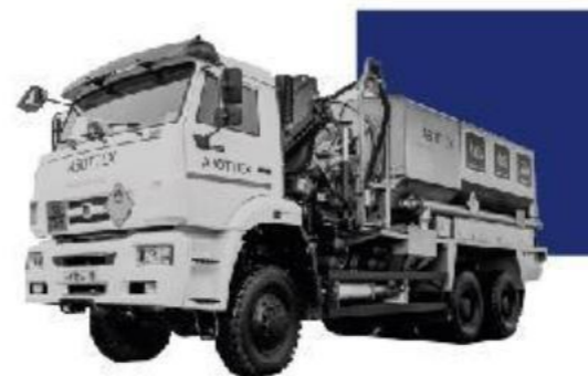
TDR.REPUMP-14-KMY Тип ВВ: эмульсионные Заказчик: АО «Полюс Вернинское» Шасси: КАМАЗ
